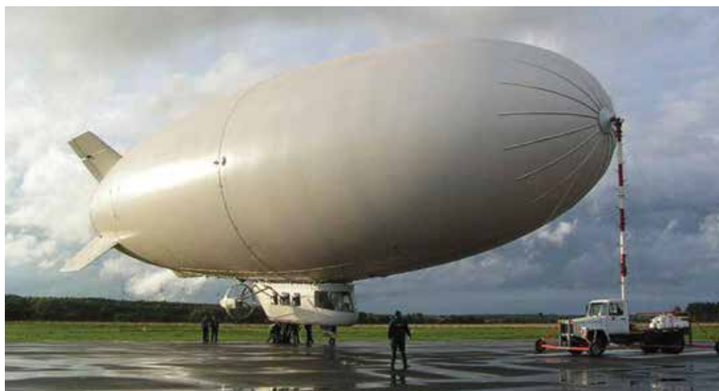
Рис. 5. Российский дирижабль «Атлант» способен перевозить грузы весом до 250 т на расстояние до 5 тыс. км.
